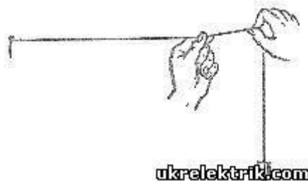
Рис. 2. Разметка при помощи разметочного шнура или отвеса со шнуром
